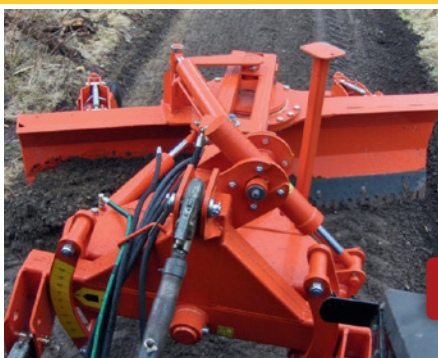
Planierschild GT-250DKH Arbeitsbreite 250 bis 300 cm
